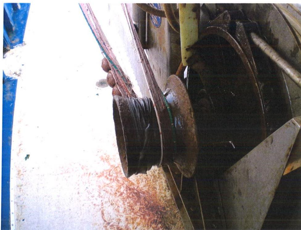
**Figura 6 – Particolare del recupero della sciabico tramite "campana" del verricello**
