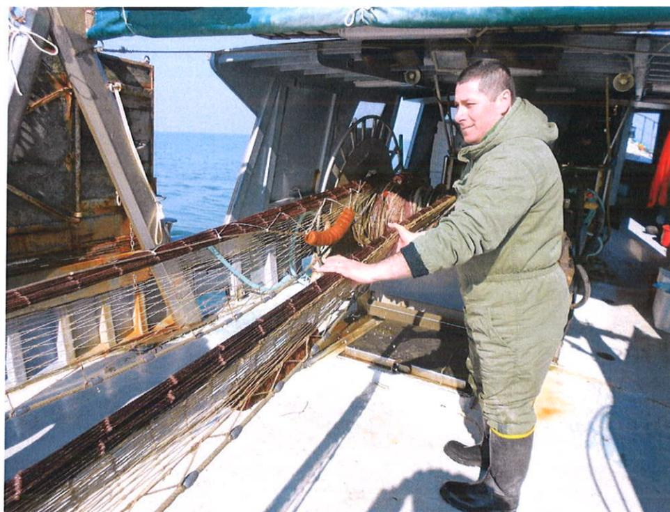
**Figura 9 – Fase di raccolta della rete sul tamburo**
