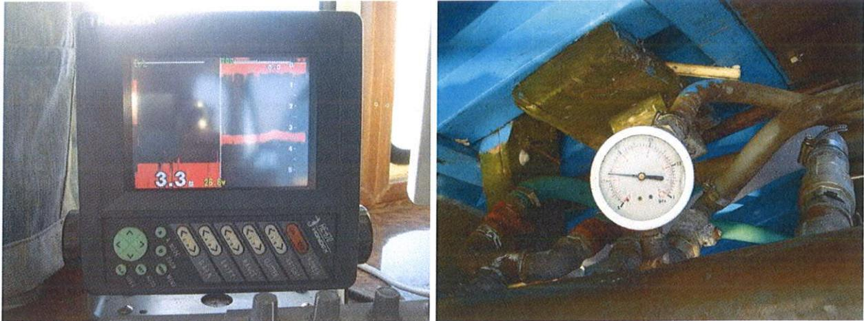
**Foto 4.9: Ecoscandaglio per la profondità e manometro per la pressione dell'acqua.**
