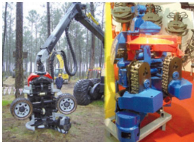
**Foto 8.** Due modelli di teste abbattitrici ed allestitrici. L'organo di taglio è rappresentato da una barra scanalata su cui scorre una catena tagliente.
