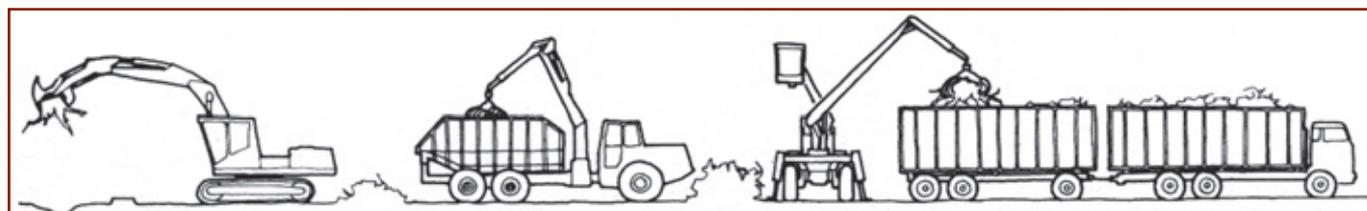
**Figura 11.** Estrazione di ceppie con sistema Pallari; gli apparati radicali vengono lasciati in campo per alcuni mesi, permettendo alla pioggia di dilavare il terreno.
