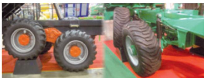
**Foto 20.** Sulla sinistra sistema di assale a bilanciere con trazione idraulica; sulla destra sistema idraulico di sterzata e livellamento degli assi del rimorchio.
