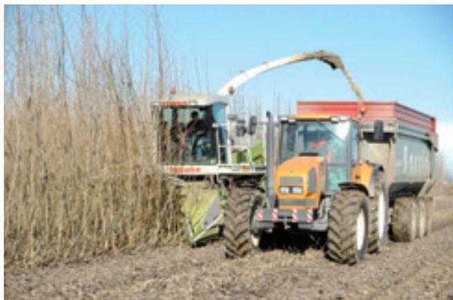
**Foto 44.** Il trattore procede affiancato alla trinciatrice, una volta pieno, trasporta il cippato al punto di scarico mentre un secondo trattore lo sostituisce.
