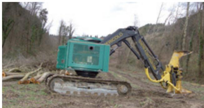
**Foto 7.** Abbattimento con testa abbattitrice a disco montata su macchina industriale, nella meccanizzazione avanzata.
