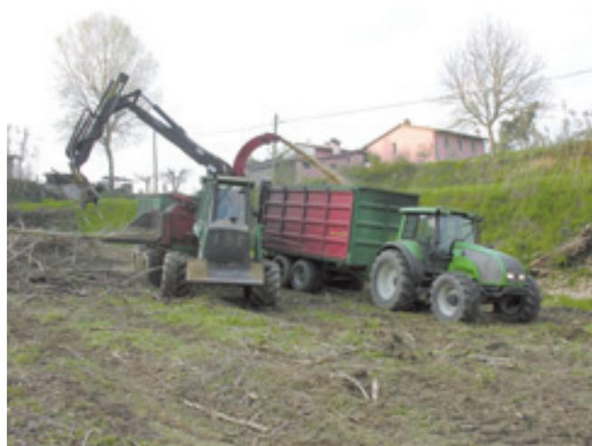
**Foto 32.** Sminuzzatrice montata su forwarder che lavora parallelamente ad un trattore con rimorchio per il trasporto delle scaglie.
