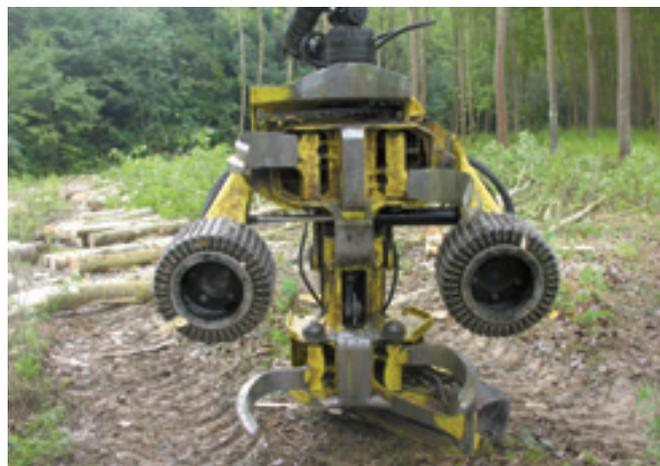
**Foto 12.** Testa abbattitrice-allestitrice munita di doppia barra per la sezionatura.
