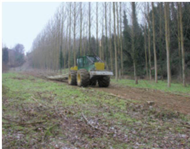
**Foto 2.** Esbosco di fusti sramati per il successivo allestimento all'imposto.
