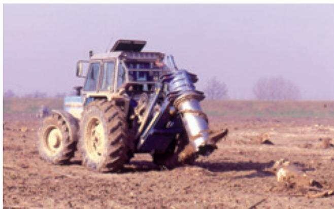
**Foto 33.** L'estratte a trivella è costituito da un cilindro largo a sufficienza da contenere il fittone di un pioppo maturo.
