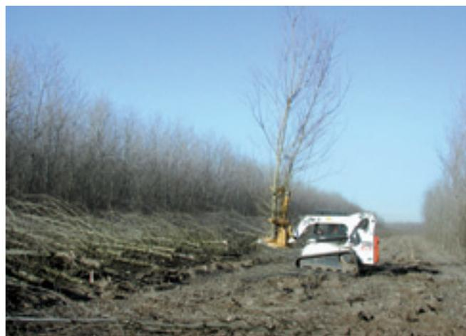
**Foto 54.** Un mini abbattitore-accumulatore può maneggiare fino a due piante per ciclo di lavoro.
