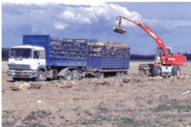
**Foto 38.** Gli autotreni riescono a muoversi direttamente dentro il campo se il terreno è asciutto, in questo modo il caricatore li può riempire rapidamente riducendo di molto i tempi di attesa.
