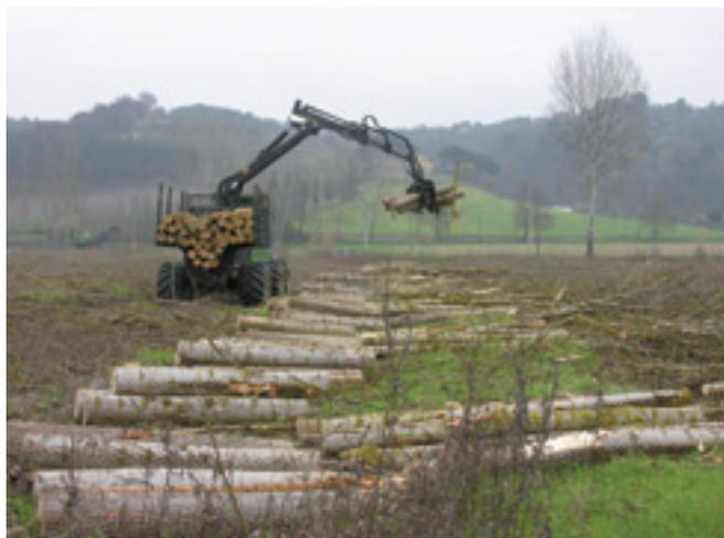
**Foto 25.** Esbosco con forwarder, fase operativa di carico del materiale.
