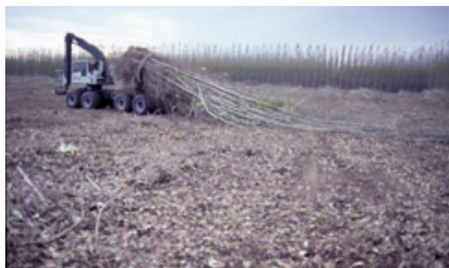
**Foto 49.** Quando il carico è completo l’abbattitrice si sposta lateralmente e lascia a terra il fascio di piante pronto per essere trasportato fuori campo.
