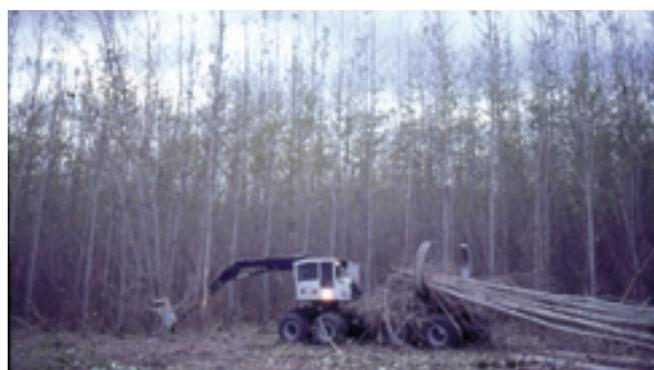
**Foto 48.** Una macchina dedicata può essere utilizzata come alternativa all’escavatore. Il modello qui riportato abbatte le piante e le carica nella pinza posteriore.
