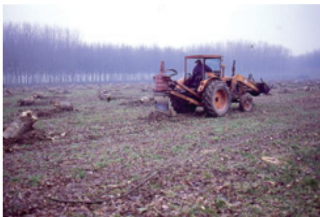
**Foto 37.** Un estrattore di ceppaie a trivella montato su trattore agricolo al lavoro in un pioveto.
