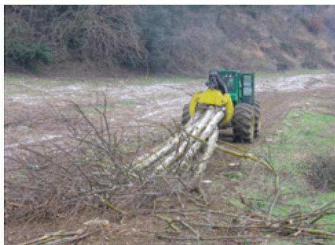
**Foto 28.** Esbosco di piante intere per semistrascico con skidder.
