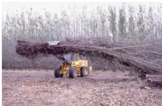
**Foto 50.** Una potente pala gommata viene utilizzata per trasportare il fascio di piante sino alla piazzola di scarico.
