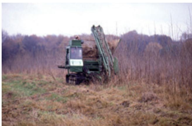
**Foto 41.** Questo prototipo di abbattitrice cingolata raccoglie i fusti interi e li carica nel pianale posteriore.
