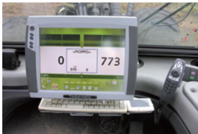
**Foto 11.** Schermo del computer di bordo di cui sono equipaggiati i più moderni harvester.
