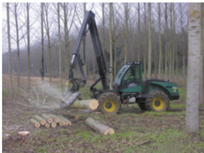
**Foto 14.** Harvester durante l'allestimento della pianta.
