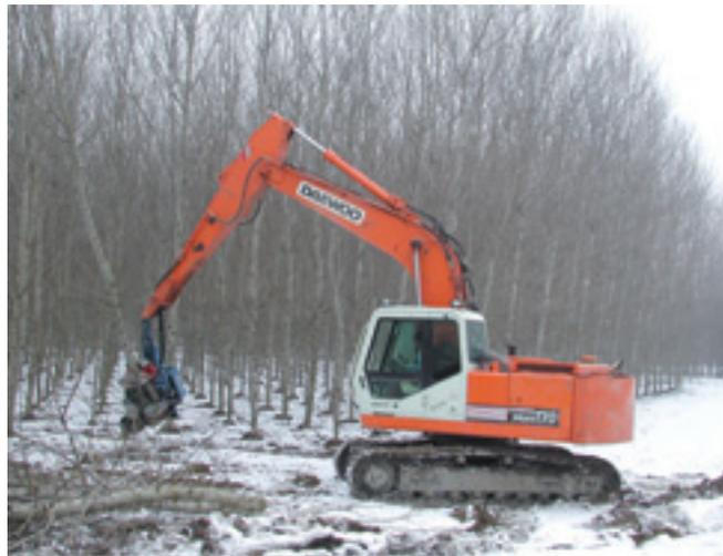
**Foto 55.** Un abbattitore basato su escavatore può abbattere e allestire le piante accumulando i cimali e i tronchi in diversi cumuli o diverse file.
