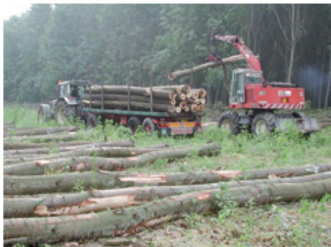
**Foto 3.** Utilizzo di un caricatore munito di pinza idraulica nella meccanizzazione tradizionale avanzata.
