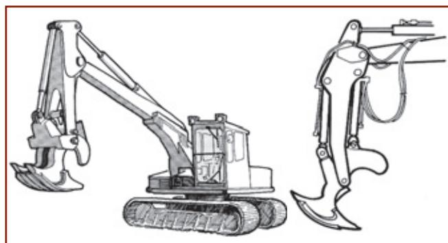
**Figura 10.** La pinza Pallari montata su uno scavatore e un dettaglio in profilo dell'attrezzo.
