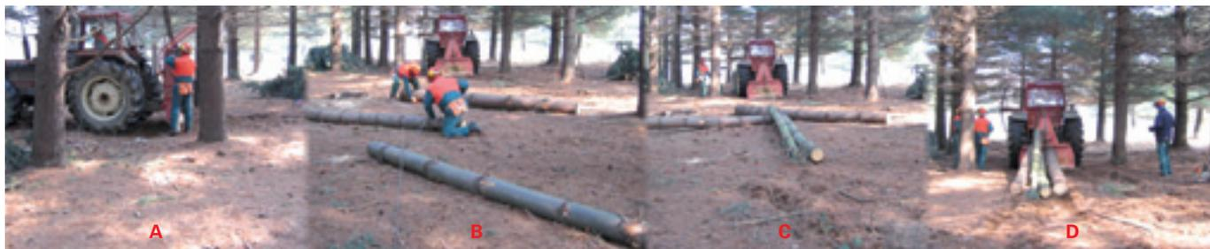
**Foto 19.** Operazione di esbosco per strascico indiretto con verricello forestale a un tamburo di tipo mobile o portato.
