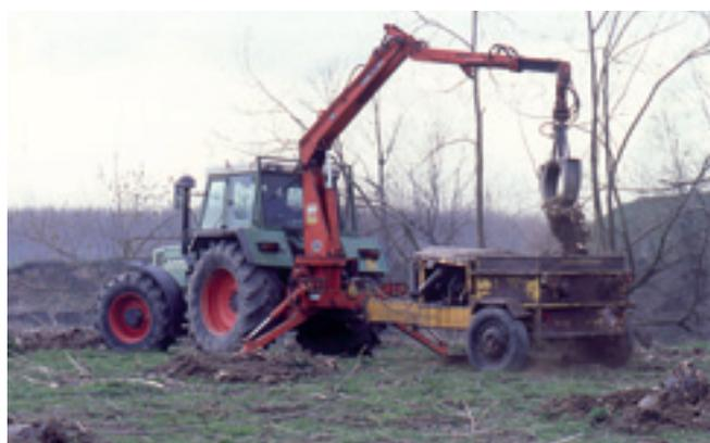
**Foto 35.** Il pulitore può essere azionato da un comune trattore agricolo, ma in questo caso sarà necessaria una pompa idraulica addizionale per alimentarlo assieme al braccio idraulico.
