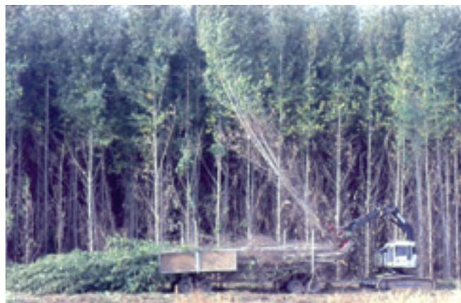
**Foto 52.** L'abbattimento viene effettuato con testate a disco, montate su motrici dedicate. In questo caso il mezzo traina anche il rimorchio per piante intere.
