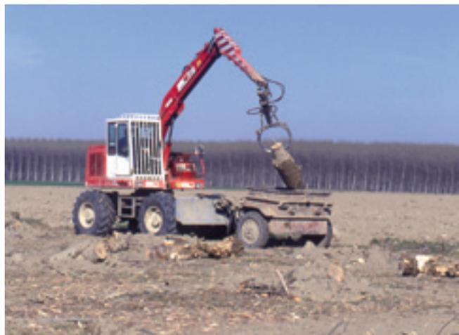
**Foto 34.** Un caricatore forestale può trainare e azionare il pulitore a flagelli mantenendo invariate la sua mobilità e produttività.
