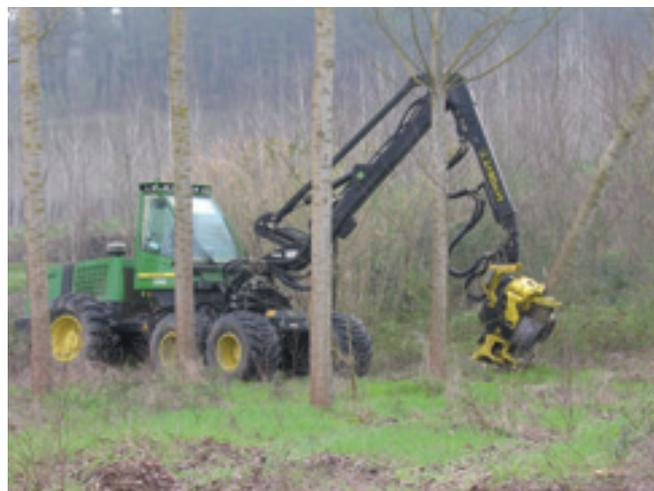
**Foto 9.** Abbattimento ed atterramento con harvester.
