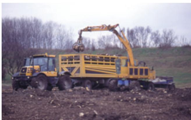
**Foto 39.** I trattori veloci con rimorchi a tre assi potrebbero essere un buon compromesso tra mobilità fuori pista e velocità su strada.
