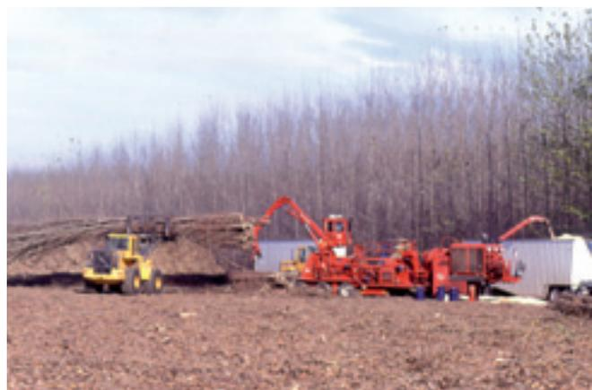
**Foto 51.** Allo scarico l'unità cippatrice-sramatrice-scortecciatrice carica direttamente i rimorchi.
