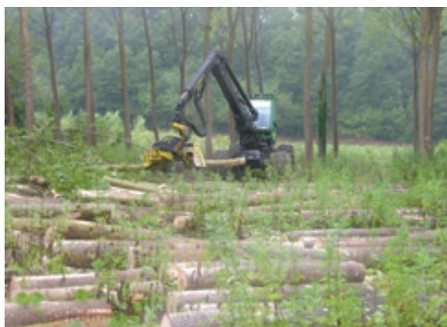
**Foto 13.** Posizionamento della pianta per l'allestimento.
