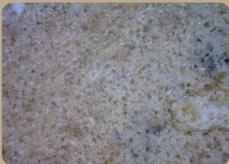
Fig. 3c - Superficie dopo la pulitura con acqua e blanda spazzolatura (55x) (E. Zendri)
