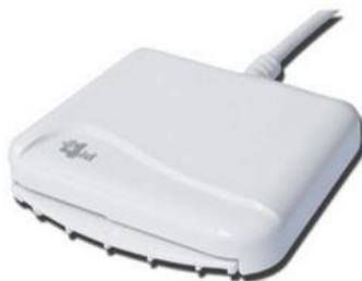
Si tratta di un dispositivo Plug&Play compatibile con gli standard ISO-7816 e EMV (livello 1) in grado di supportare smartcard Class A, B e C (5V, 3V e 1.8V) con microprocessori con protocolli T=0 e T=1.
