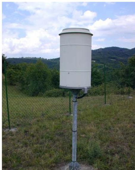
Figura 2 e Figura 3. Esempio di stazione agrometeorologica del CMT e particolare del pluviografo.
