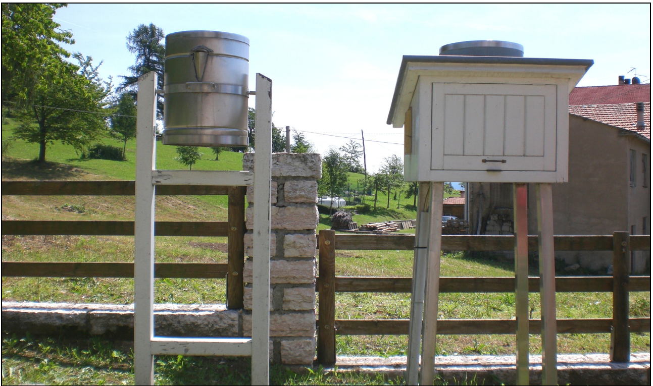
Fig.17 - Stazione storica di Tonezza del Cimone (VI) dotata di pluviometro e pluviografo
