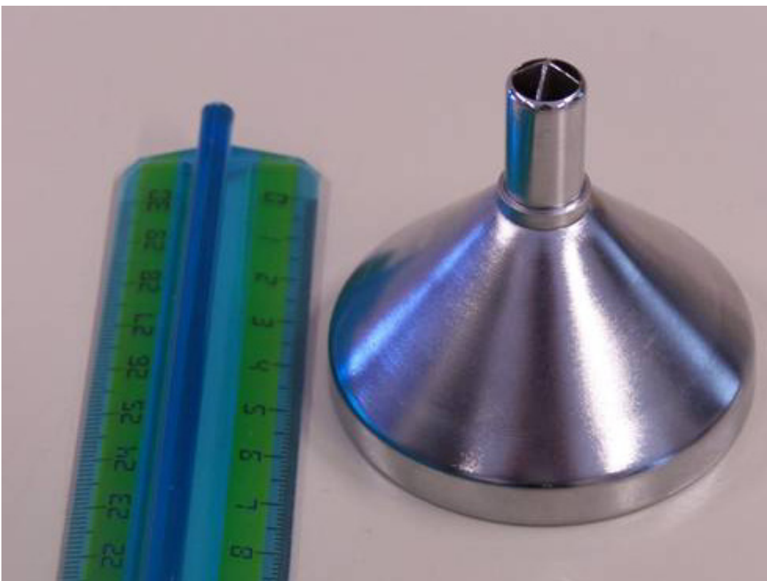
Fig.14 - Pluviografo Registratore tipo M. 20; particolare dell'imbutino con rompigoccia che convoglia l'acqua sul sistema di vaschette basculanti
