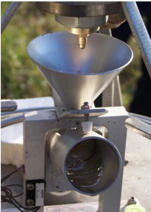
Fig.30 – Pluviometro MTX particolare del sistema di misura a bilance basculanti durante un intervento di taratura in campo: a destra fase di carico dell'acqua a sinistra fase di scarico.
