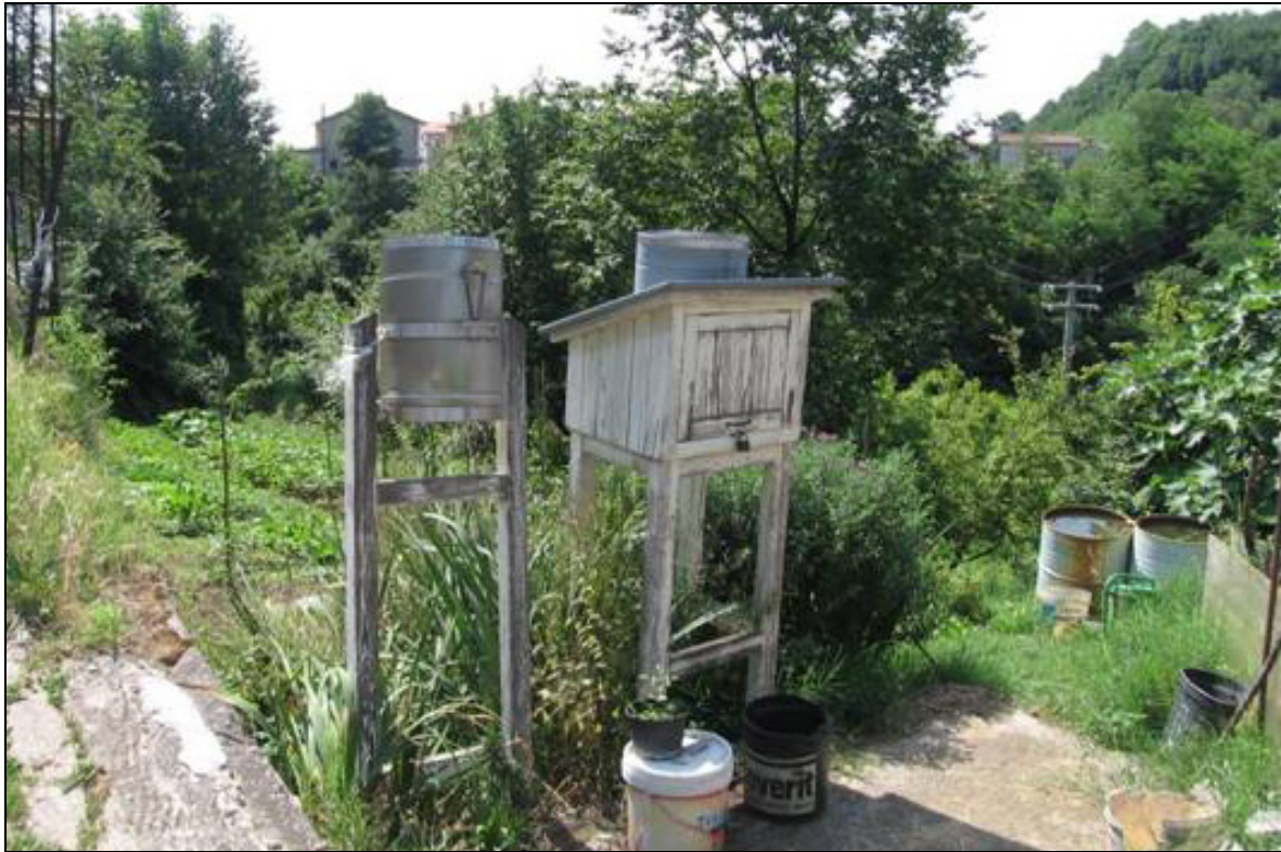
Fig.18 - Stazione storica di Crosara (VI) dotata di pluviometro e pluviografo
