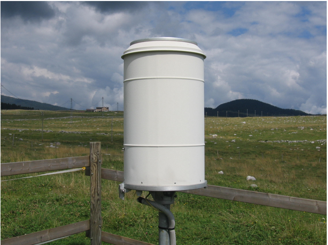
Fig.33 – Pluviometro MTX con bocca da 1000 cm 2 posizionata a 2 m dal suolo – particolare del corpo dello strumento, si osservi il piccolo deflettore per il vento collocato in prossimità della bocca di captazione
