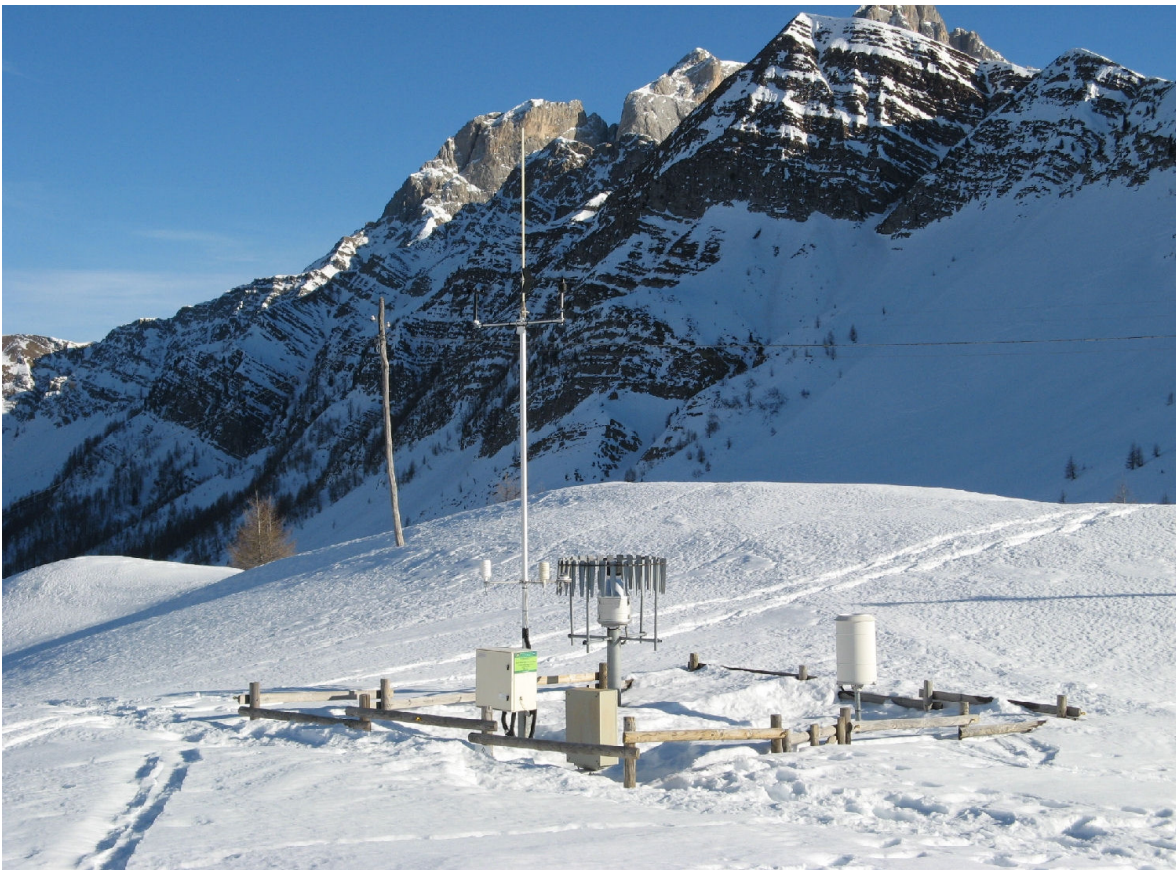
Fig.37 – Stazione meteorologica di Passo Valles (BL) è presente anche un pluviometro a pesata Geonor con schermo antivento
