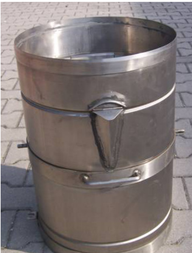
Fig.6 – Pluviometro totalizzatore C. 10: vista di fronte e particolare del beccuccio apribile per lo svuotamento dell'acqua nel cilindro graduato
