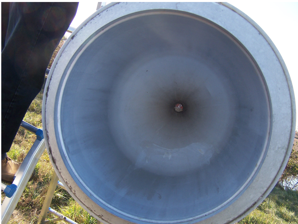
Fig.31 – Pluviometro MTX particolare dell'imbuto di raccolta in alluminio anodizzato con bocca tarata circolare di 1000 cm 2 , alla base è visibile il filtro per impedire la caduta di corpi solidi nel sistema di misura.
