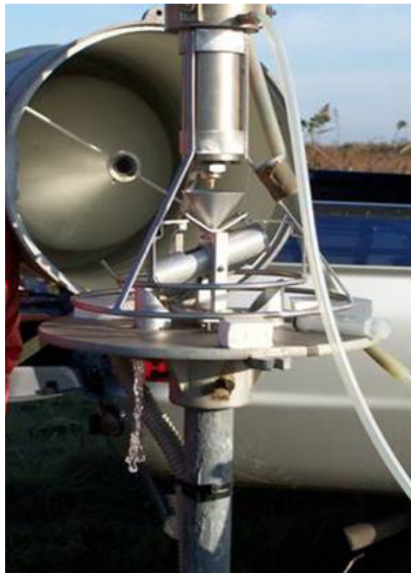
Fig.30 – Pluviometro MTX particolare del sistema di misura a bilance basculanti durante un intervento di taratura in campo: a destra fase di carico dell'acqua a sinistra fase di scarico.
