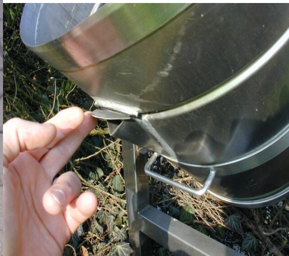
Fig.6 – Pluviometro totalizzatore C. 10: vista di fronte e particolare del beccuccio apribile per lo svuotamento dell'acqua nel cilindro graduato
