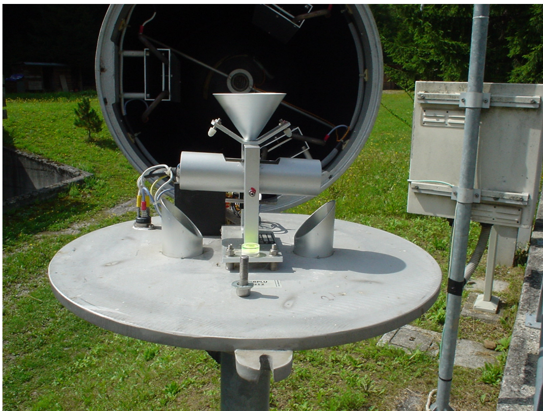
Fig.27 – Pluviometro MTX con bocca da 1000 cm 2 , il sistema di misura a bilance basculanti è stato fotografato quasi a metà della fase di rovesciamento
