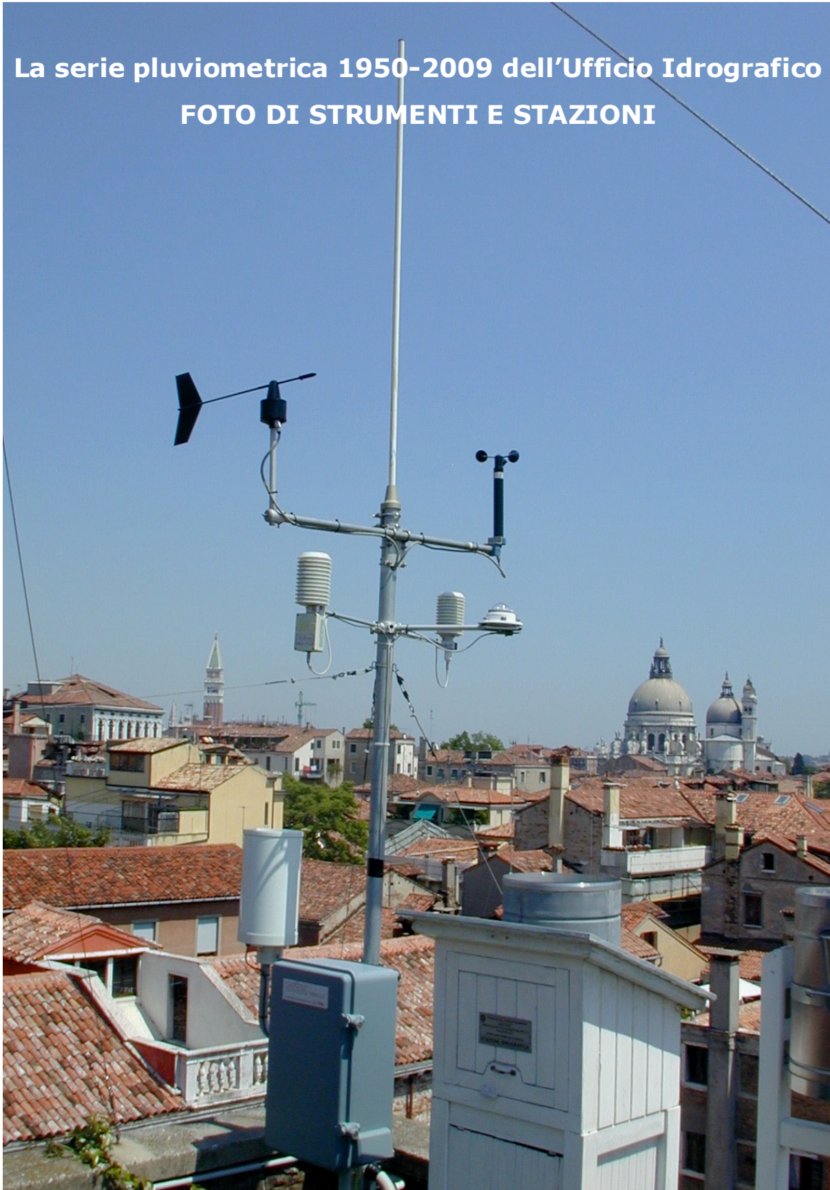
Tetto dell'Istituto Cavanis (VE) strumenti elettronici, meccanici e manuali in uno storico sito di osservazioni meteorologiche.
