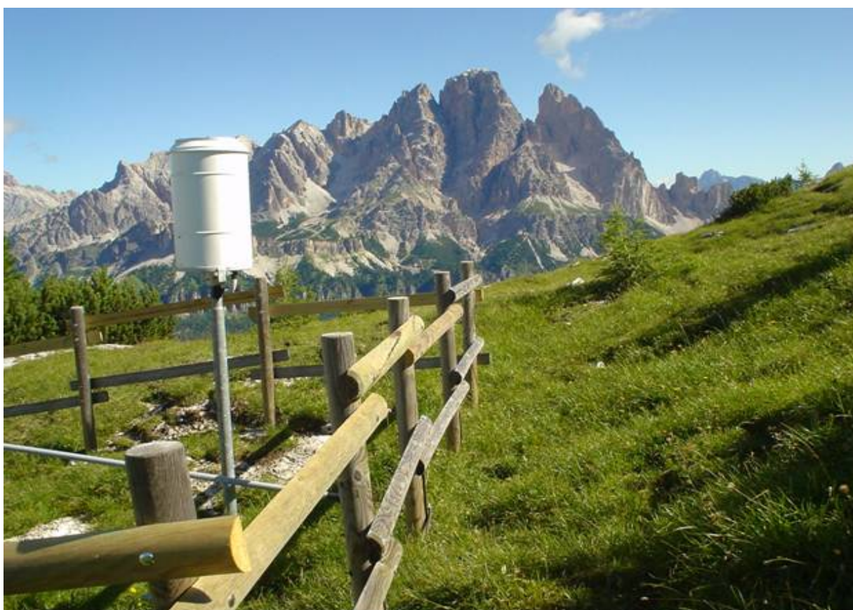
Fig.32 – Pluviometro MTX con bocca da 1000 cm 2 posizionata a 2 m dal suolo - vista d'insieme
