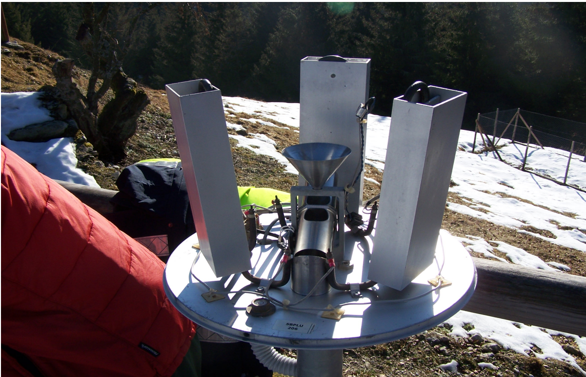
Fig.29 – Pluviometro MTX, particolare del gruppo di misura a bilance basculanti, questo strumento ha il sistema di riscaldamento a tre resistenze applicato sulla base d'appoggio. Il corpo superiore dello strumento non è rovesciabile ma sfilabile verso l'alto.
