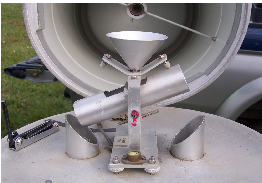
Fig.28 – Ad avvenuto rovesciamento la vaschetta di destra si porta in fase di carico d'acqua e quella di sinistra in fase di scarico, a metà del gruppo basculate e visibile l'acuminato spacca goccia, inoltre il pluviometro è privo di resistente di riscaldamento.
