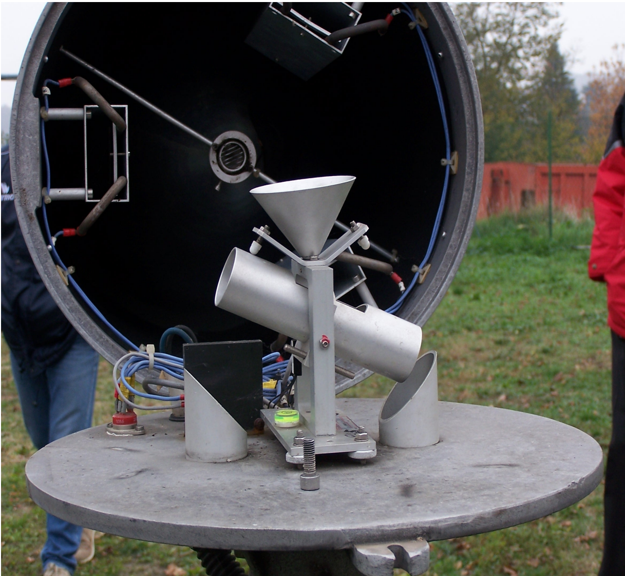
Fig.26 – Pluviometro MTX con bocca da 1000 cm 2 , particolare del sistema di misura a bilance basculanti.
