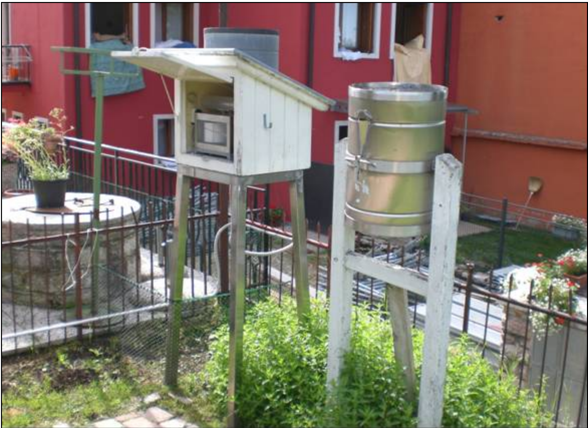
Fig.21 - Stazione storica di Foza (VI) dotata di pluviometro e pluviografo
