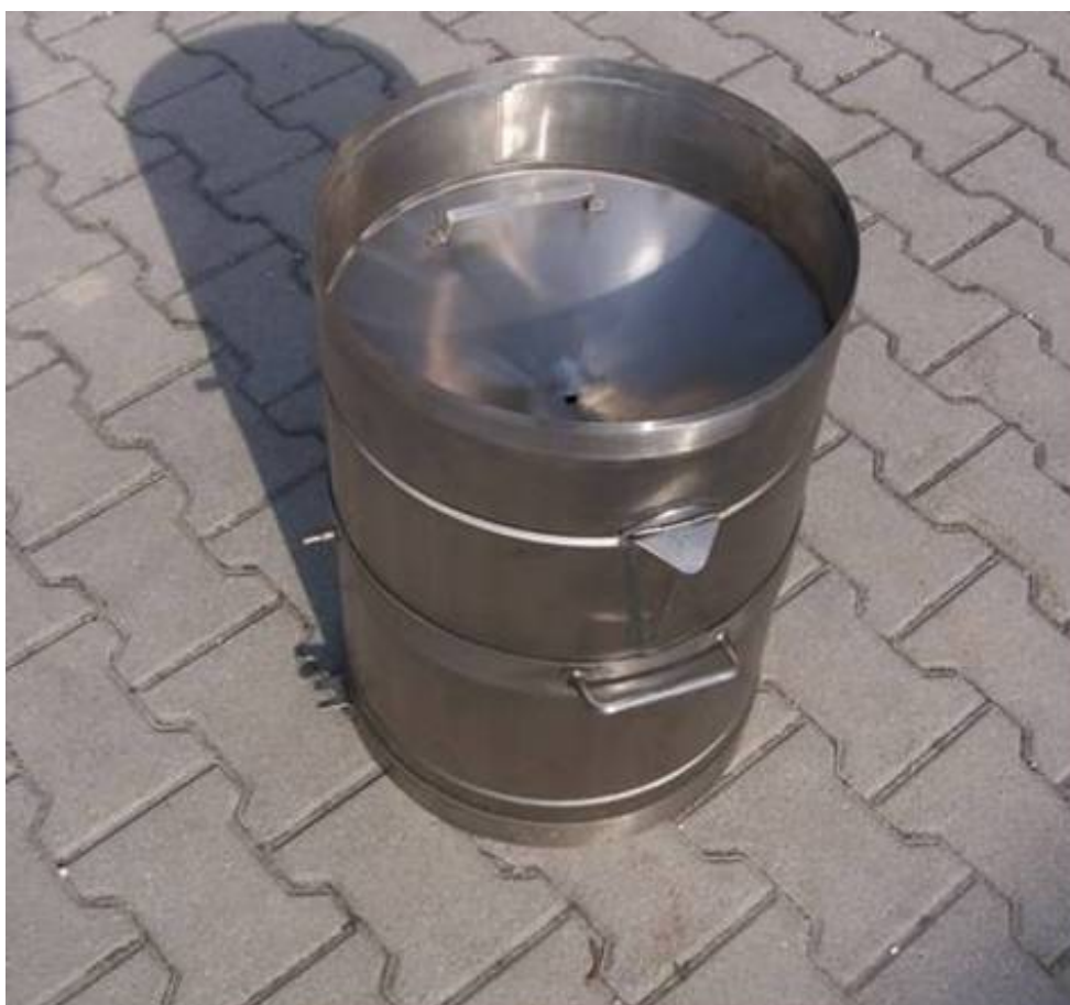
Fig.3 – Pluviometro totalizzatore C. 10 con superficie captante da 1000 cm 2 diametro 35,7 cm con coperchio conico inserito a circa 10 cm dal bordo superiore
