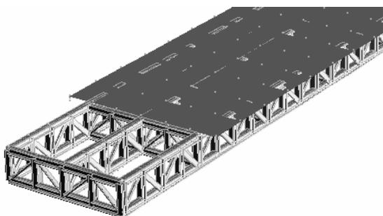
Impalcato a solettone (travi prefabbricate accostate con getto di completamento in opera)
